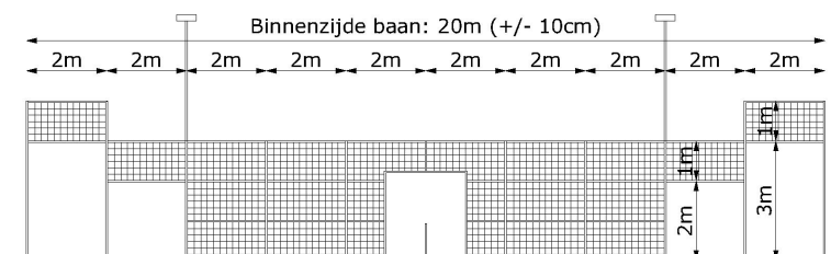
Afbeelding 2: Afmetingen zijwand (voorkeursvariant)
